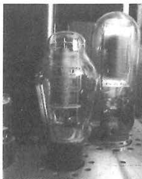
真空管の拡大。中央の300Bで右の845をドライブ。
