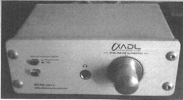
LPレコードの音(アナログ)をデジタルに変換するADコンバーター。これで古いレコード音源をパソコンのハードディスクに保存
